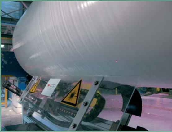
Fig 1. Système de mesure des défauts d'aplat installé sur une visiteuse.
